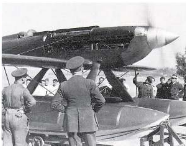
Sopra, a sinistra: il motore AS.6 a Vigna di Valle, montato su di un supporto. A destra: uno degli MC.72 ripreso durante una prova a terra del suo motore AS.6 a Desenzano del Garda, sede del Reparto AV; ai comandi vi è un motorista.
